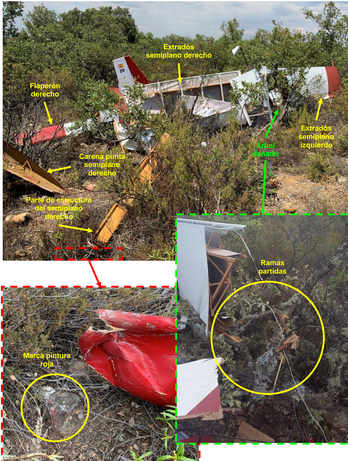
Figura 3. Fotografías tomadas del lugar del accidente durante la inspección del equipo investigador: vista posterior (1ª foto desde arriba), y vista anterior, con detalles de las marcas en el terreno (2ª foto).
