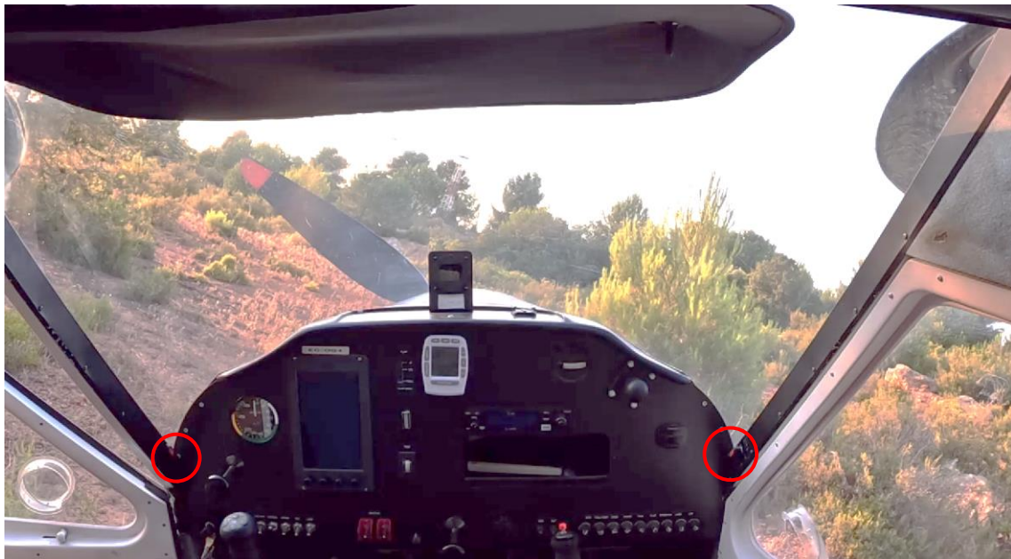
FIG. 1 UBICACIÓN DE LAS VÁLVULAS DE COMBUSTIBLE DESPUÉS DEL ACCIDENTE
