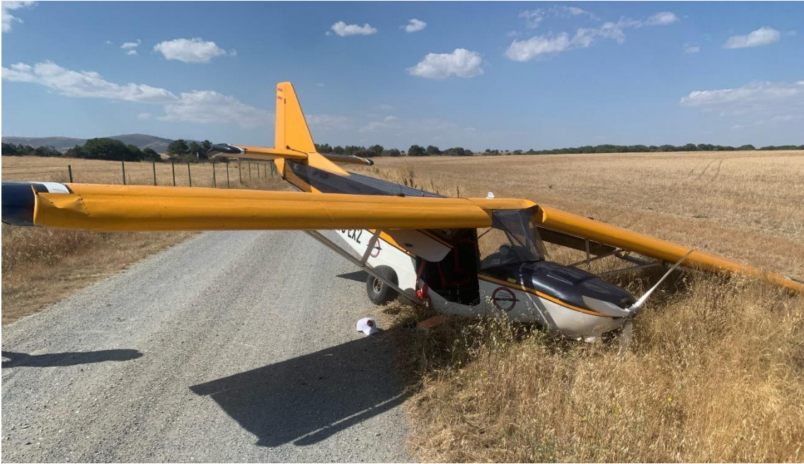
Figura 4: estado final de la aeronave tras detenerse.
