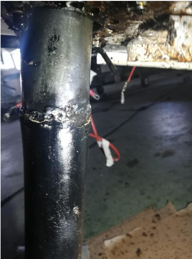
Figura 7: Reparación no autorizada en pata de morro del tren de aterrizaje.
