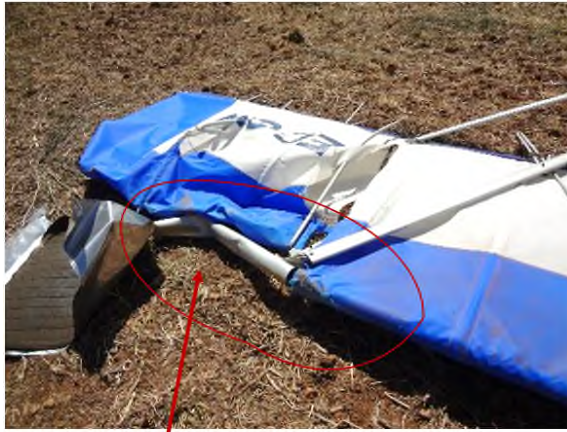
Deformación del larguero del semi-ala izquierda
