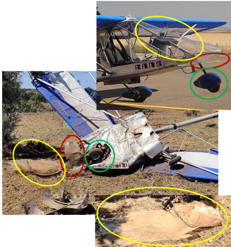
Figura 3: Daños en la parte delantera
