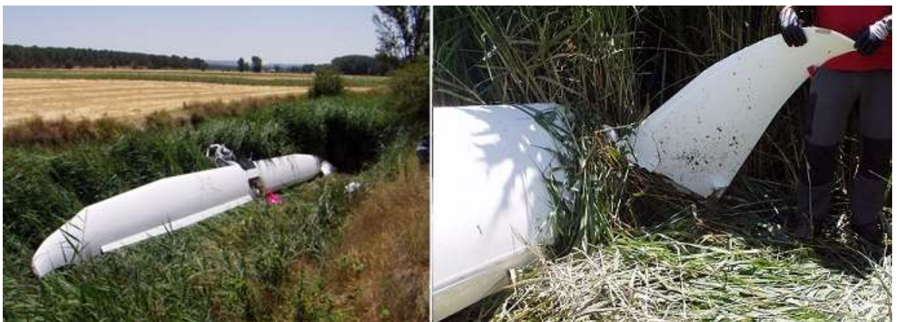
Figura 3. Planos y rotura en plano derecho
