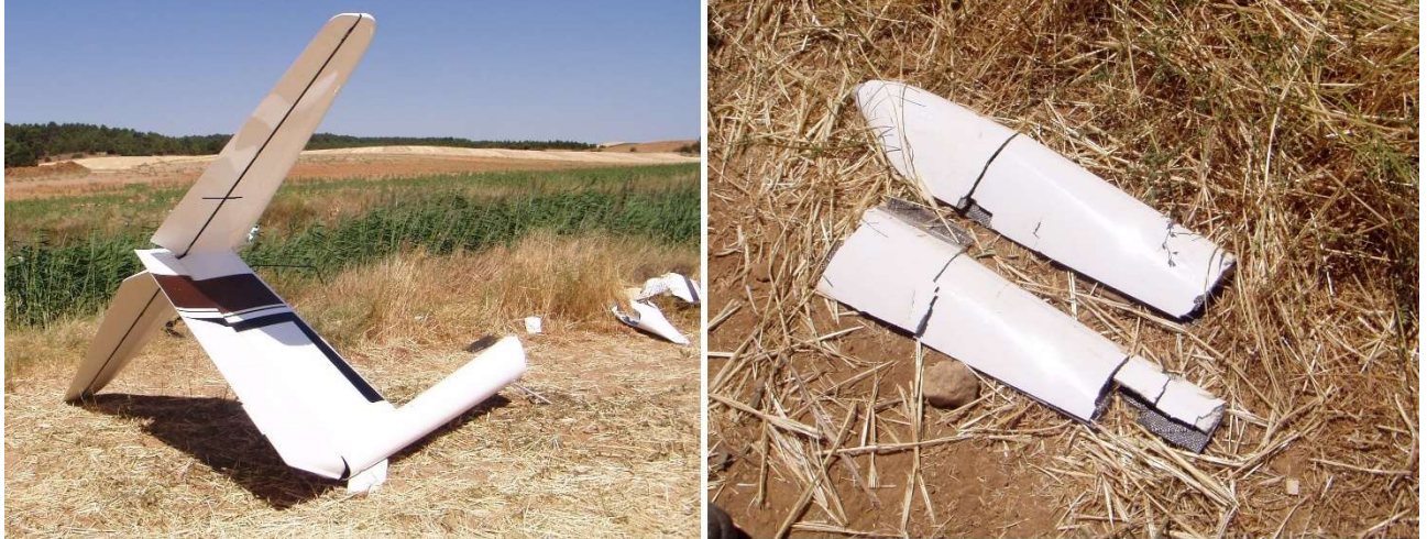
Figura 4. Empenaje y palas de la hélice
