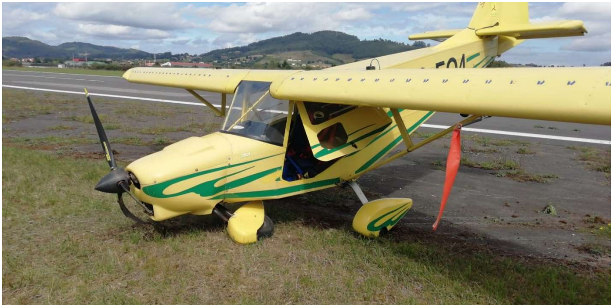
Fig. nº 1,- Posición final del ULM, fuera de pista, y daños sufridos.
