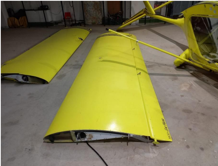
Figura 6. Planos desmontados con pocos daños
