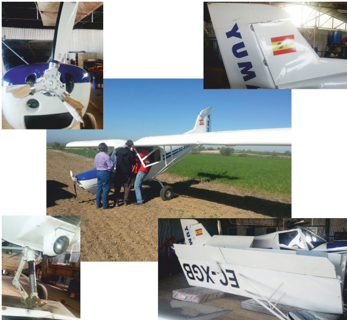
Figura 1. Aeronave en el lugar del accidente y detalles de los daños sufridos
