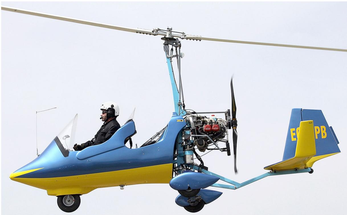
Figura 1. Autogiro ELA 07-R 115, matrícula EC-ZPB, vista lateral en vuelo
