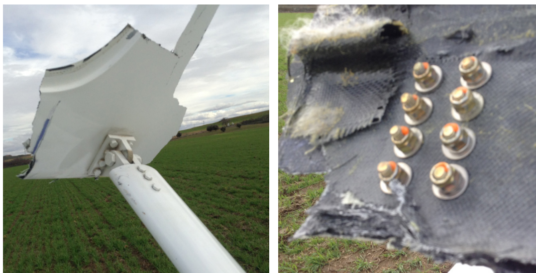
Figura 7. Anclaje de la riostra al fuselaje por ambas caras
