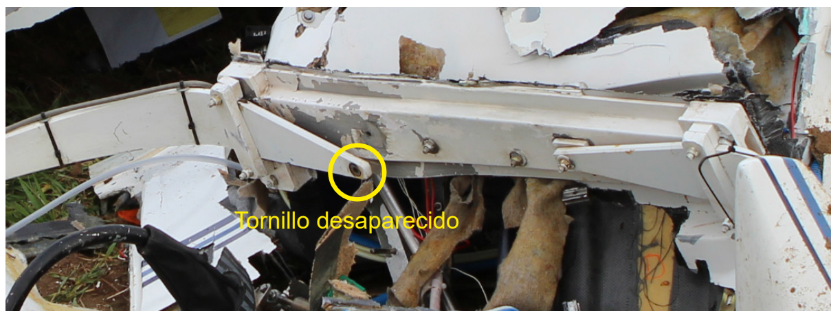
Figura 6. Estado del tren principal
