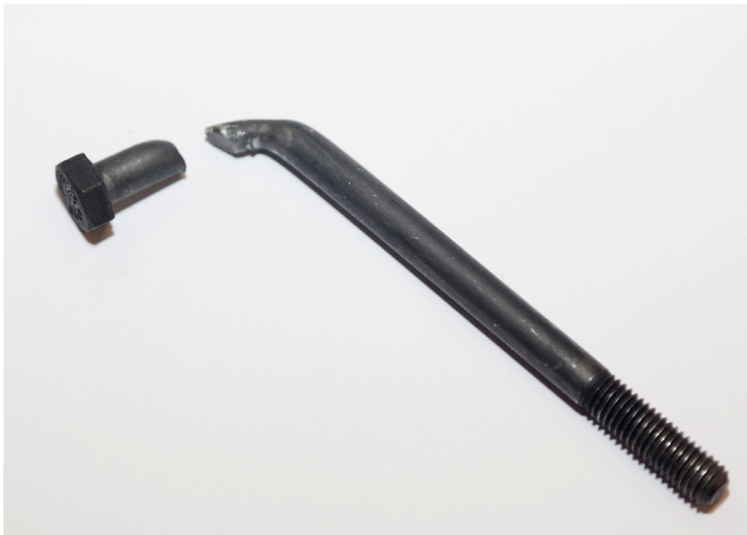
Figura 11: Detalle de la rotura del tornillo central del tren principal
