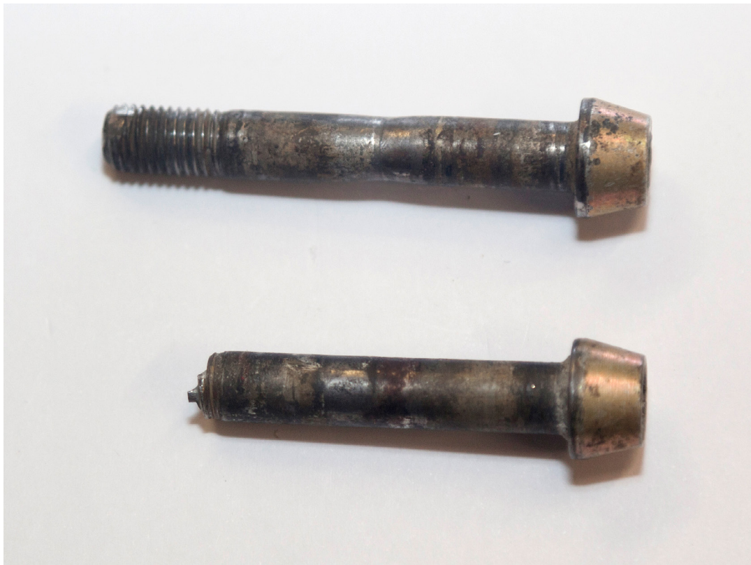
Figura 7: Detalle de los tornillos laterales del tren principal
