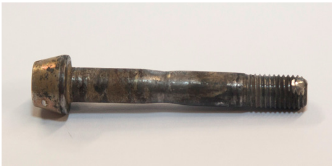
Figura 10: Detalle del tornillo lateral del tren principal que no sufrió rotura
