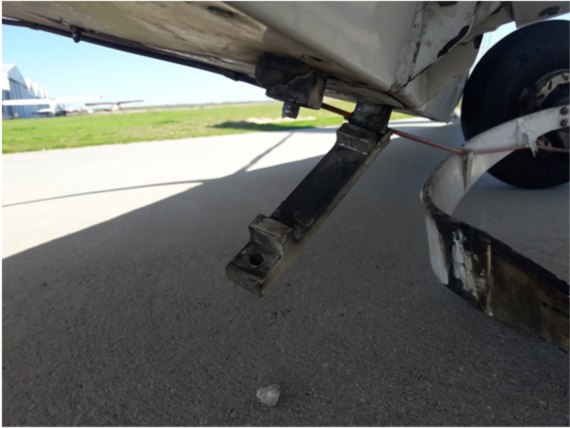
Figura 6: Detalle de la rotura de la ballesta del tren principal
