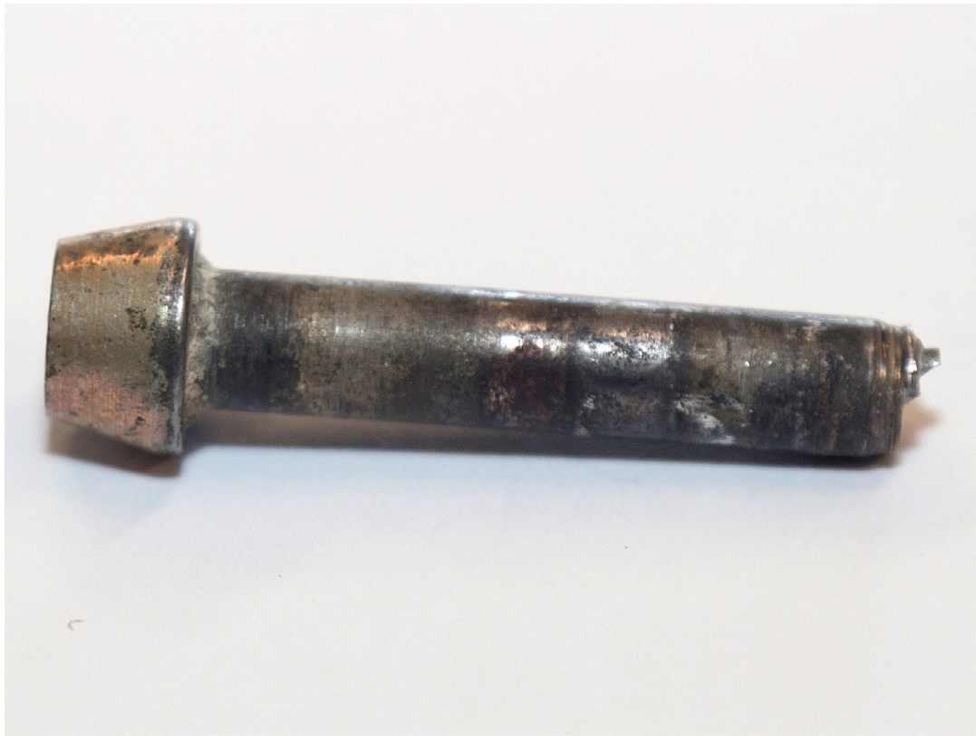
Figura 8: Detalle de la rotura del tornillo lateral del tren principal
