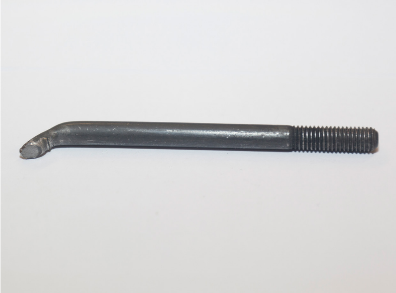
Figura 13:Detalle de la rotura del tornillo central del tren principal
