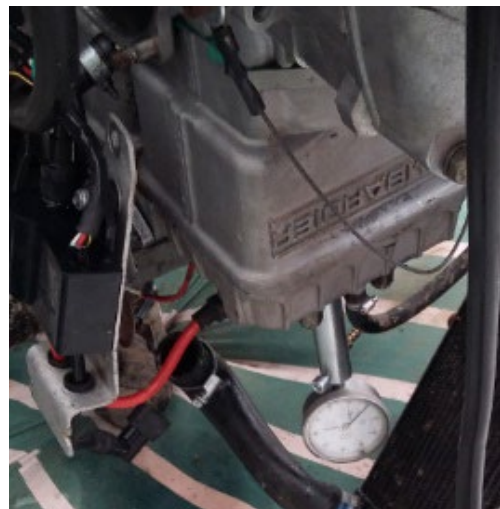
Ilustración 10: Posición de la válvula rotativa en el punto muerto superior
