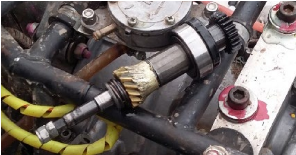
Ilustración 9: Piñón del eje de la válvula rotativa y de la bomba de agua que se encontró desgastado
