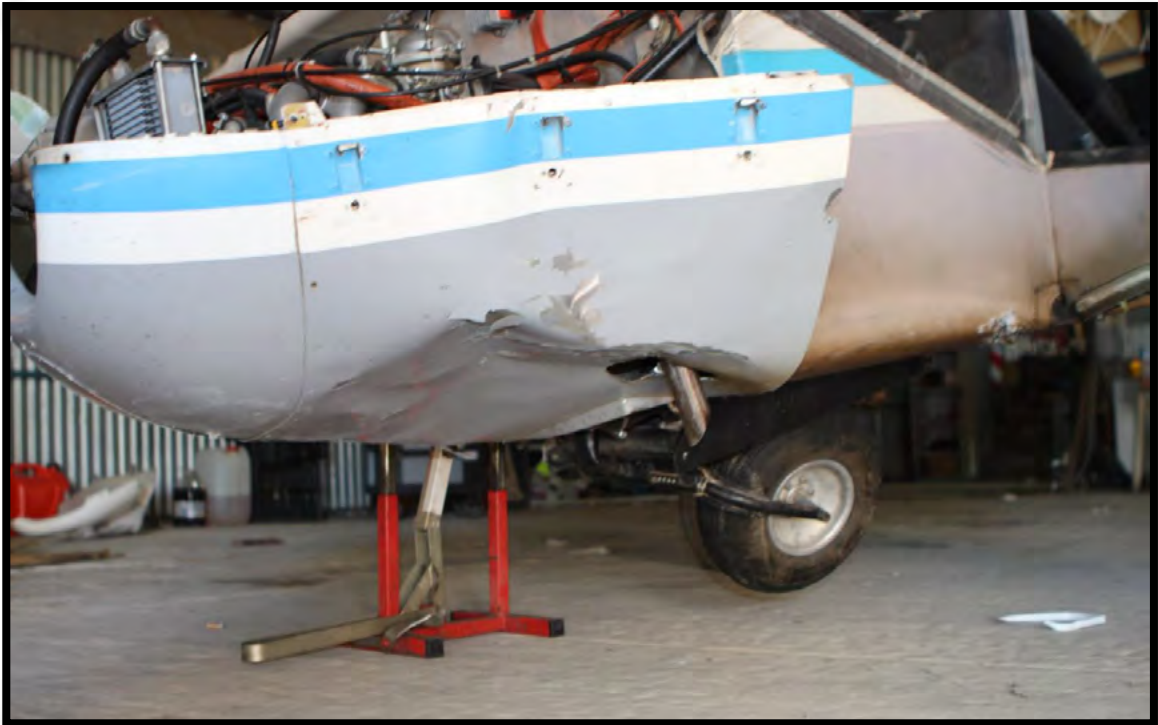
Figura 9: Daños en la aeronave – tren de aterrizaje y parte inferior delantera del fuselaje.
