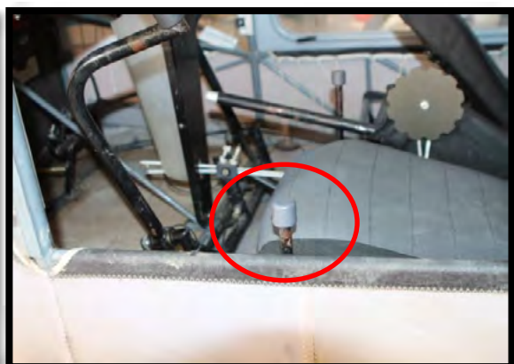
Figura 13: Palanca de gases en el puesto de piloto en la posición de mínima potencia vista desde el exterior de la aeronave.
