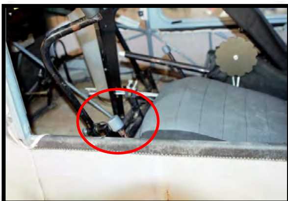
Figura 12: Palanca de gases en el puesto de piloto en la posición de máxima potencia vista desde el exterior de la aeronave.
