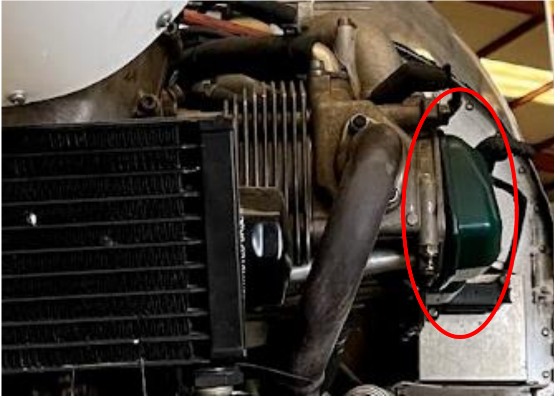
Figura 15: Vista desde el frente del motor. Obsérvese la incorrecta colocación de la tapa de balancines del cilindro 2, separada de su asiento.
