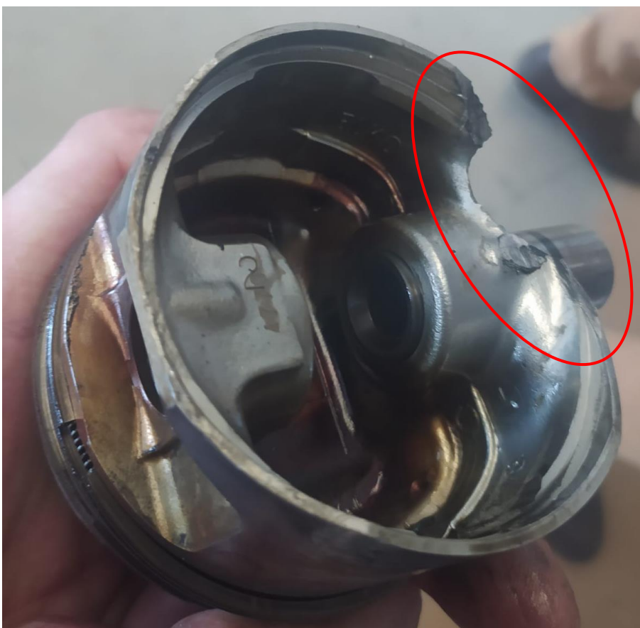
Figura 21: pistón del cilindro 2, dañado en su falda, cerca del bulón.
