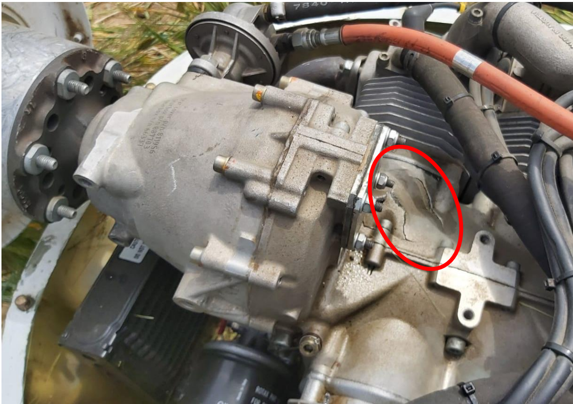
Figura 13: rotura en la parte superior del cárter
