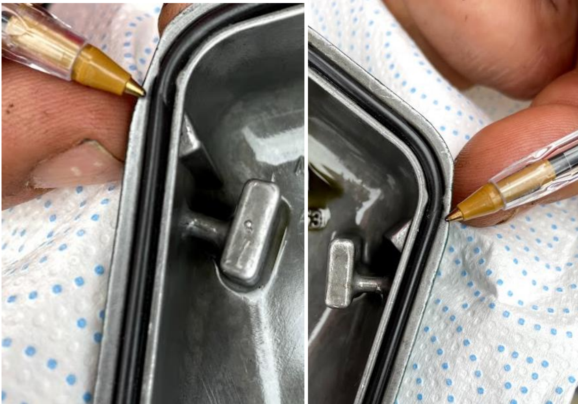
Figuras 19 (izquierda) y 20 (derecha): Muecas en la junta tórica causadas por el apriete de la tapa de balancines estando la junta tórica en mala posición.
