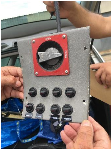
Fotografía 15. Válvula selectora de combustible
