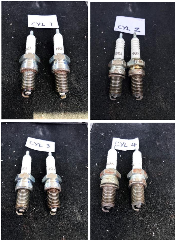
Fotografía 14. Bujías del motor del accidente
