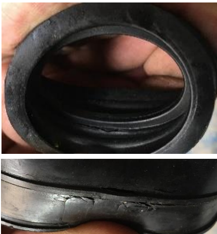
Fotografía 17. Manguito de admisión agrietado
