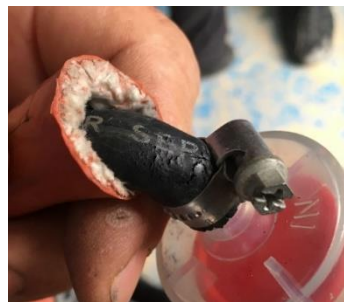
Fotografía 18. Manguito agrietado entrada filtro de combustible
