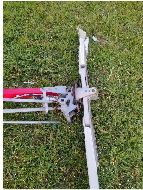
FIG. 7 DAÑOS EN EL ROTOR PRINCIPAL
