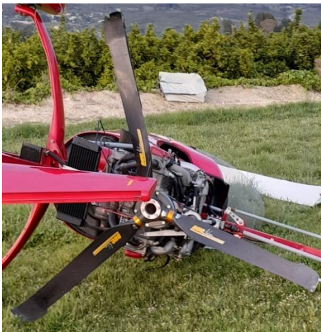
FIG. 8 DAÑOS EN LA HÉLICE
