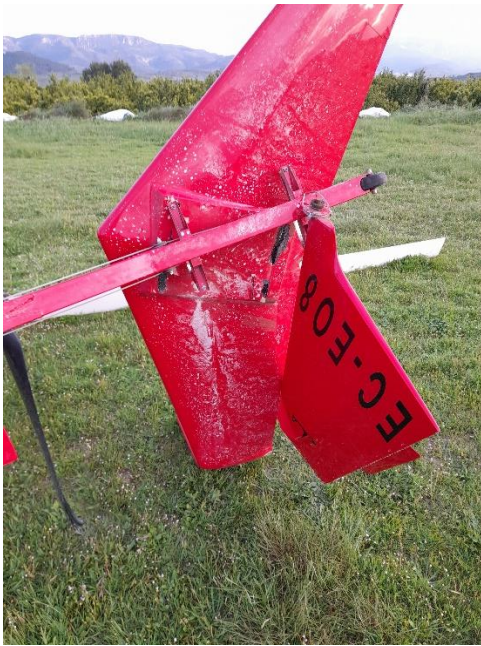
FIG. 6 DAÑOS EN EL ESTABILIZADOR VERTICAL Y HORIZONTAL
