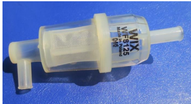
Figura 1. Filtro de combustible
