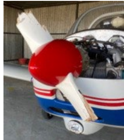
Fotografía 6. Daños en hélice
