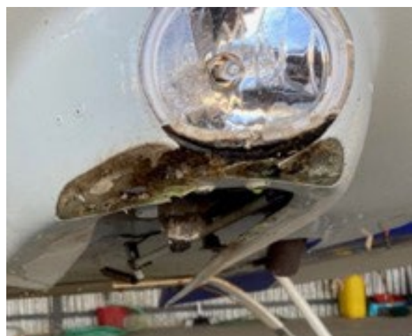
Fotografía 5. Daños en encastre del tren de morro
