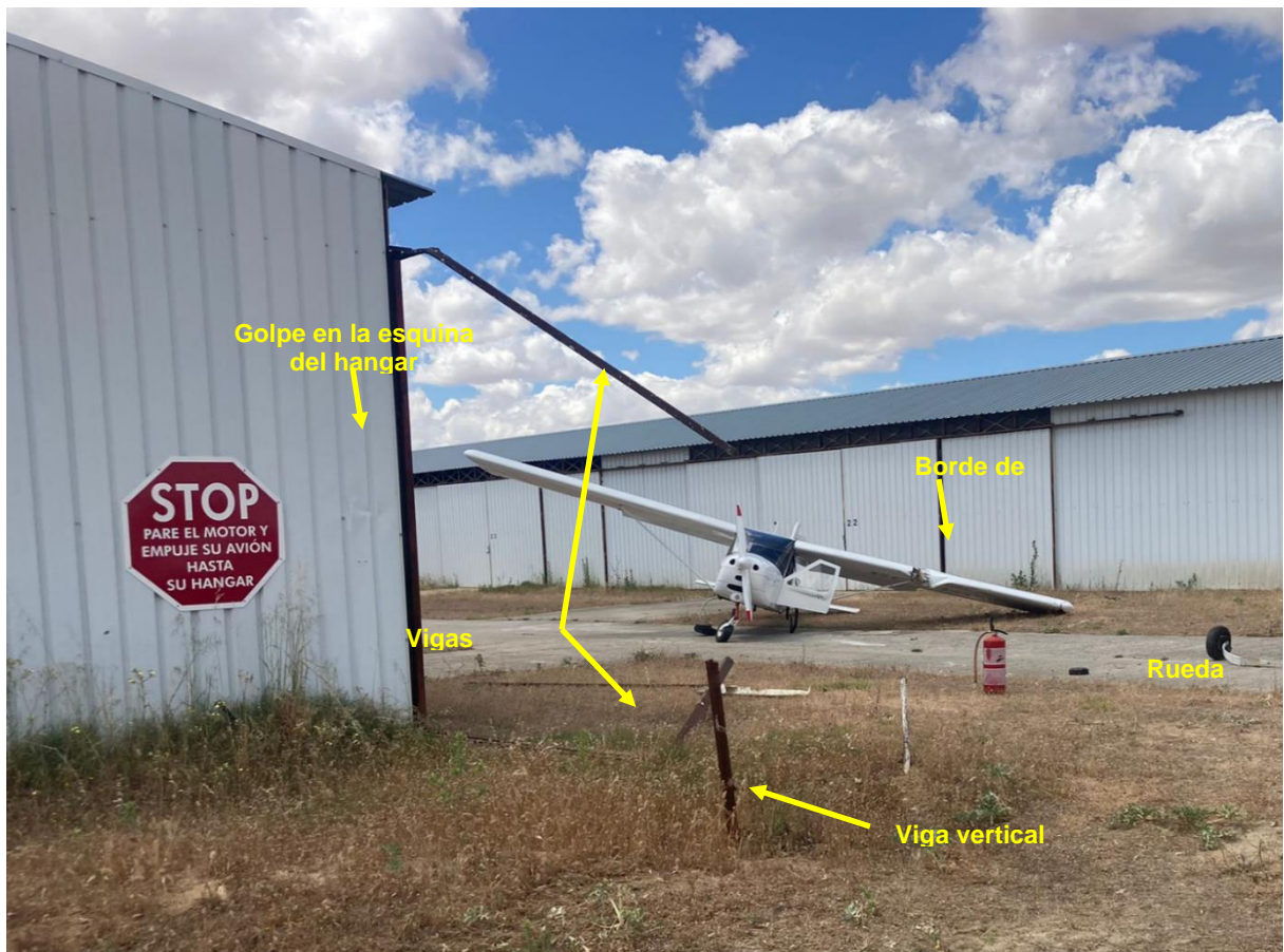
Figura 6. Daños en la aeronave y el hangar
