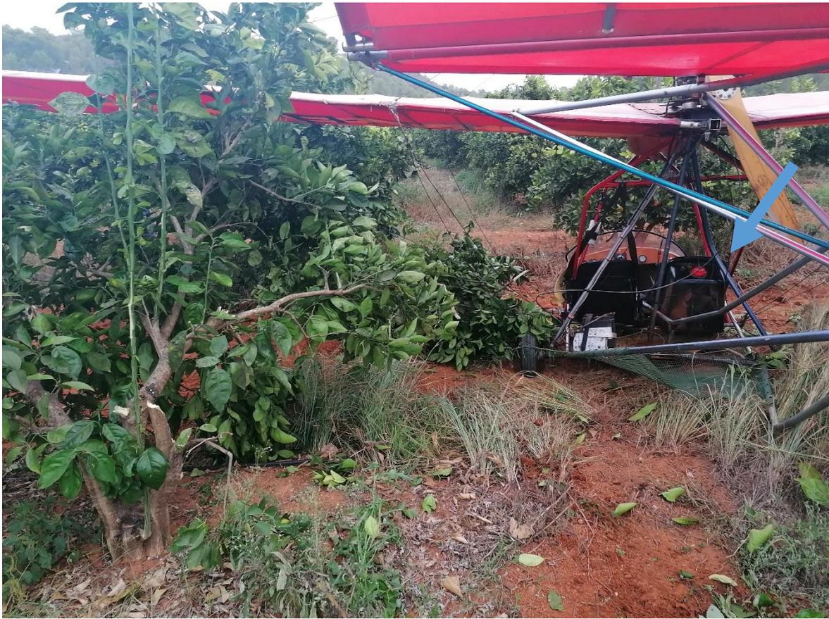
*Figura 6: detalle de daños en el tubo de cola*
