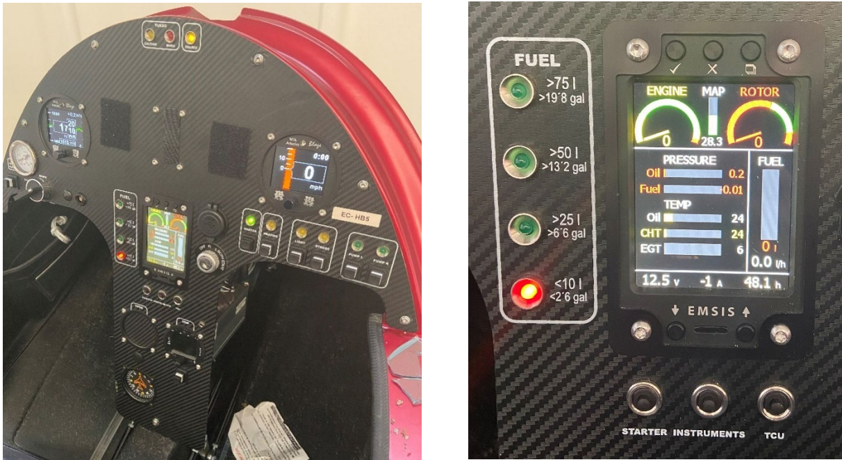
Ilustración 7: Vista general del panel de instrumentos, izquierda, y detalle de KANARDIA EMSIS y de los indicadores de nivel de combustible, derecha
