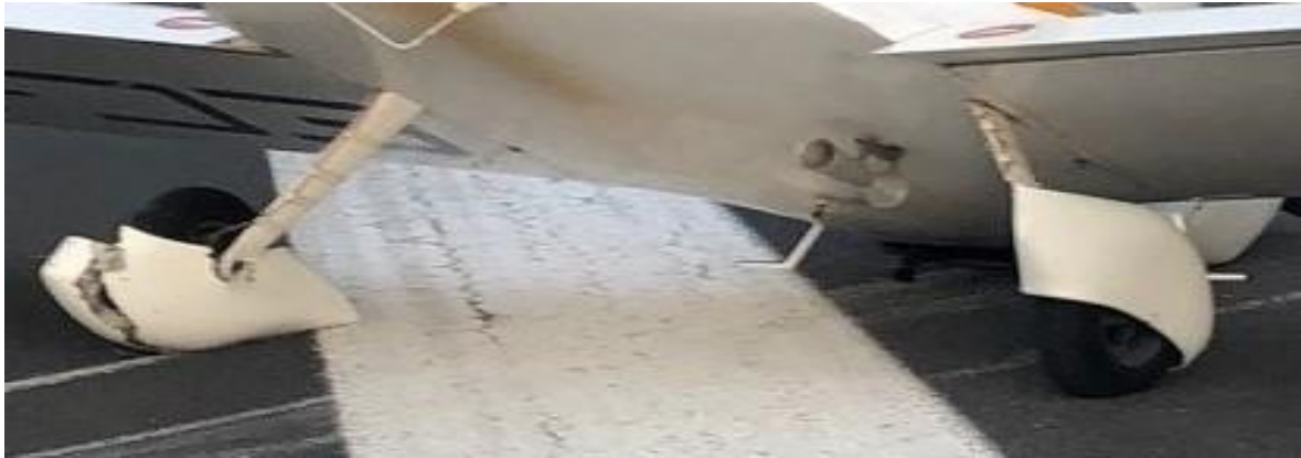
Fotografía 7. Daños en tren principal
