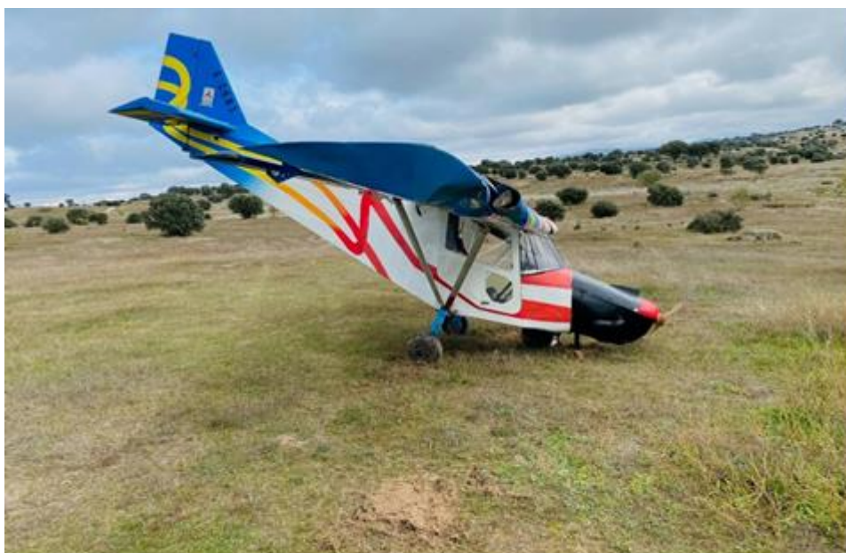
Figura nº 1.- Estado del ULM tras el aterrizaje de emergencia.
