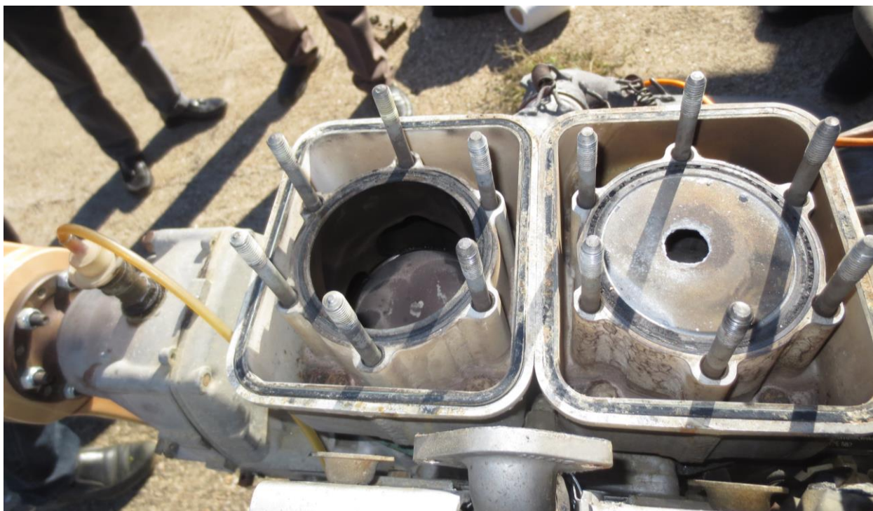
Figura nº 3.- Estado de los pistones del motor Rotax 582 UL s/n 39-57276.
