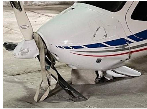
Fotografía 8. Daños en el morro y parte inferior del fuselaje
