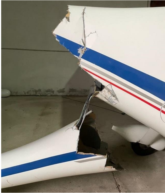
Fotografía 14. Daños en parte trasera del fuselaje
