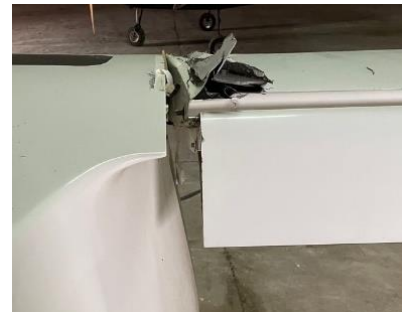
Fotografía 13. Daños en encastre del ala derecha
