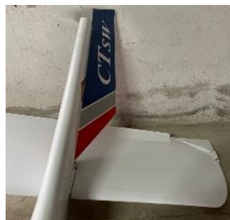
Fotografía 12. Daños en estabilizador horizontal
