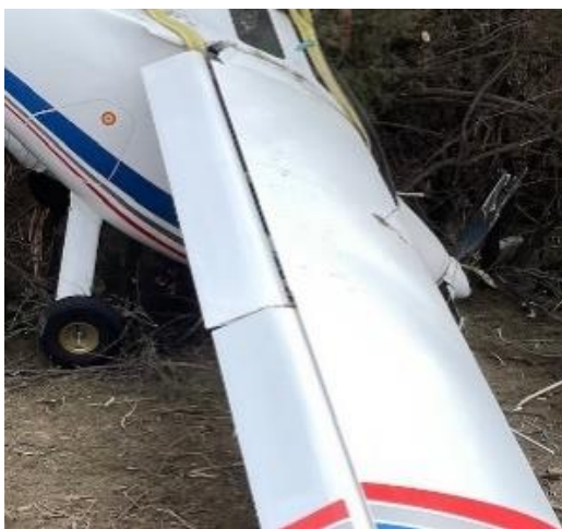
Fotografía 6. Posición de los flaps en el momento del impacto
