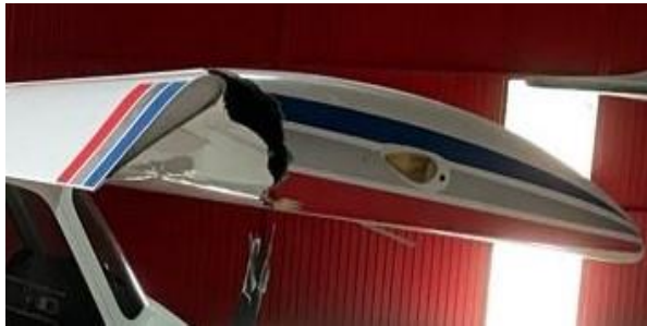
Fotografía 9. Daños en extremo del ala derecha
