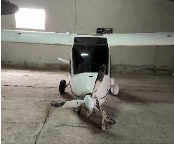
Fotografía 7. Daños en la hélice
