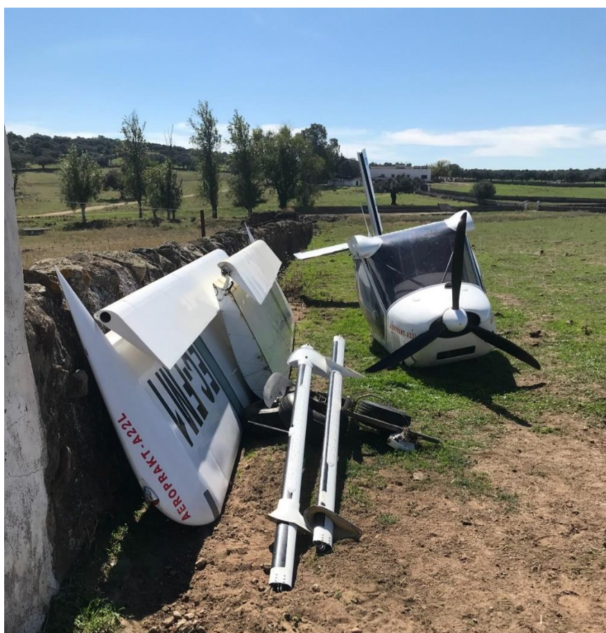
Fig. 1: Vista frontal de la aeronave tras el accidente, una vez fueron desmontados los semiplanos, sus riostras y la pata izquierda y derecha del tren de aterrizaje principal
