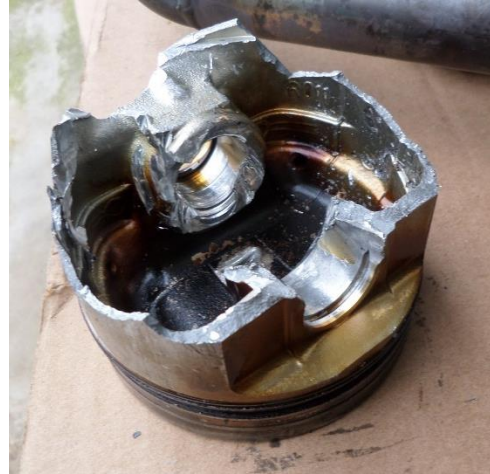
Fig. 6: Pistón del 3 y alojamiento (roto) de su bulón
