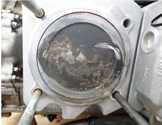
Fig. 5: Pistón del 3 con huellas circulares por contacto con las válvulas
