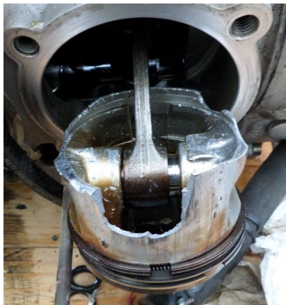
Fig. 8: Pistón del 4 con su biela y bulón
