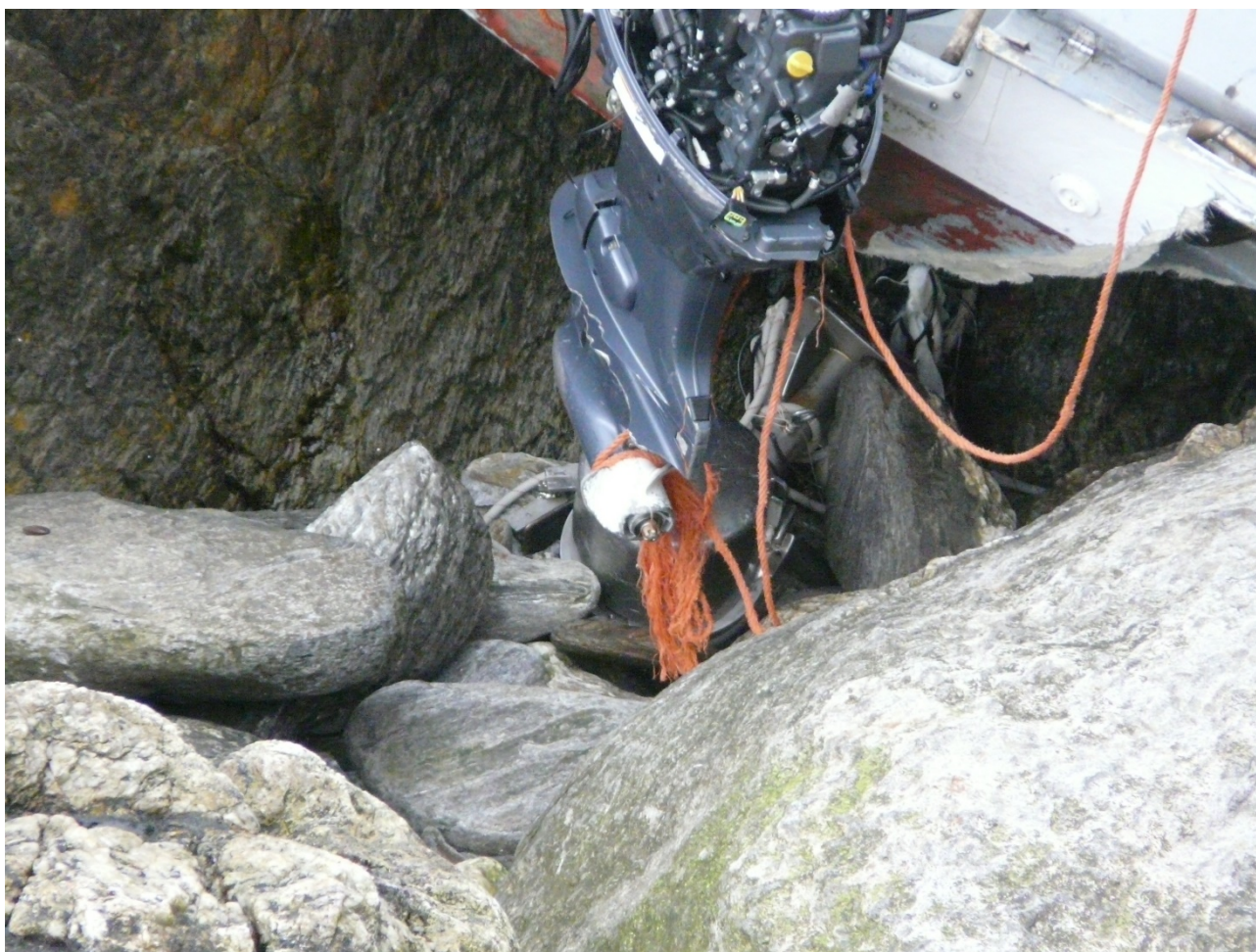
Figura 6. Detalle de la driza de un aro salvavidas atrapando la hélice.
