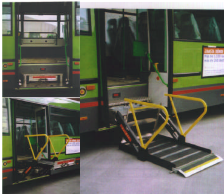
Plataforma elevadora en el interior de los peldaños, instalada en una puerta ya existente
