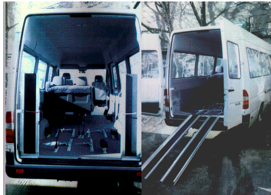
Rampa de dos elementos.
