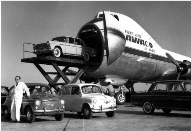
El ATL-98 CARVAIR era un Douglas DC-4 modificado, inicialmente pensado para operar en el Canal de la Mancha entre Francia y el Reino Unido. Su cabina sobrelevada y las dos grandes compuertas de carga en el morro permitían transportar hasta tres turismos y 23 pasajeros. Aviaco operó tres de estos aparatos entre 1964 y 1968 en la línea Barcelona-Palma de Mallorca, permitiendo llegar al viajero a su destino con su propio automóvil.
