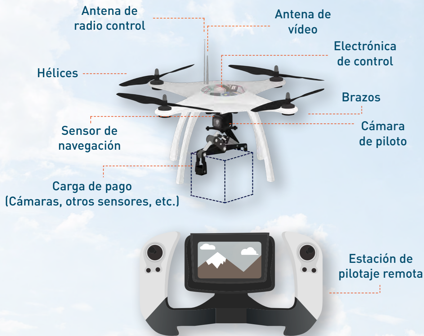
Figura 3: Elementos básicos de un dron multirrotor. Fuente: Elaboración propia.
