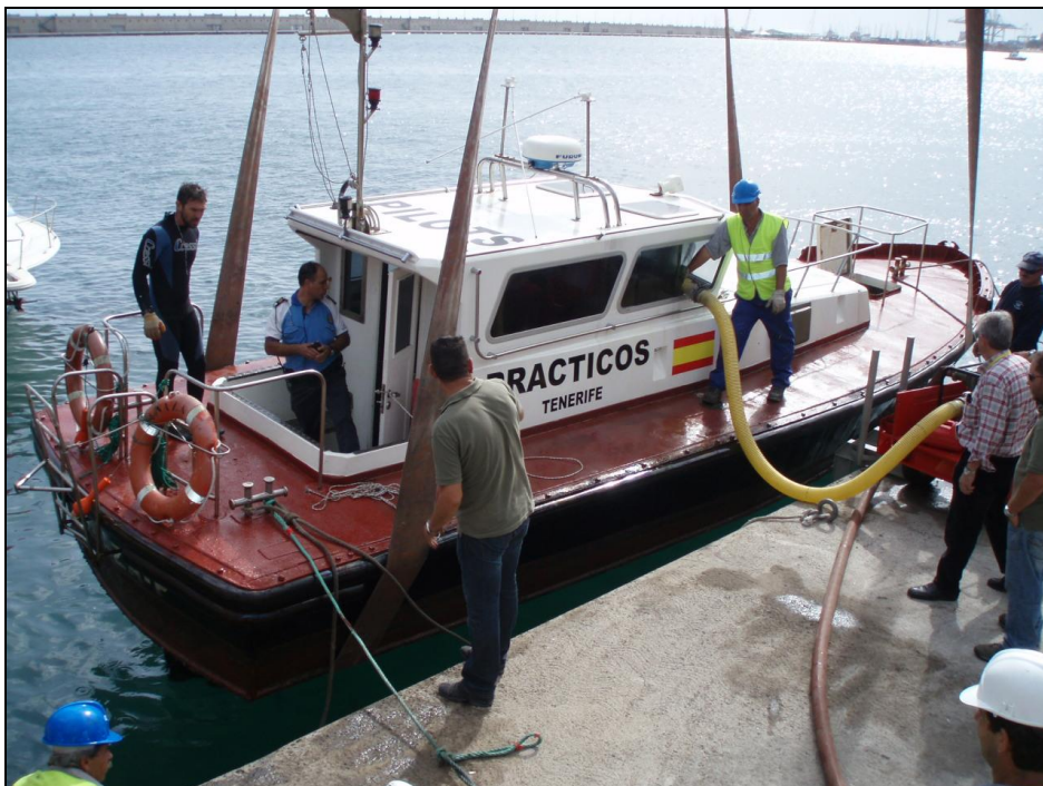
Fotos 5 y 6: Reflote con flotadores y achique antes del izado de la embarcación “Añaza P”
