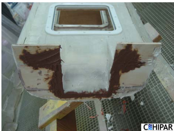
Figura 4: Detalle de la rampa de pesca durante la fase de construcción del modelo
