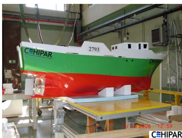
Figura 9: Modelo en la mesa de inercia. Obsérvese la simulación pintada de negro de las aperturas de la banda de babor, correspondientes a la puerta de salabardeo y al puerto de basuras.
