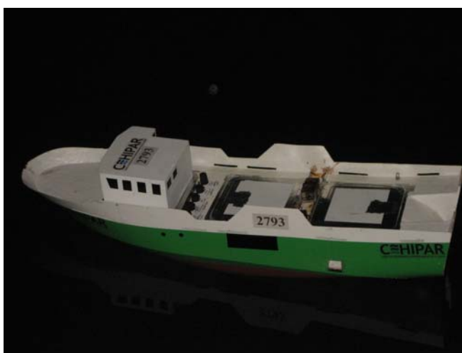
Figura 14: Situación de ensayo correspondiente a la Fase 4b, pudiendo observar la apertura al costado del tronco de basuras.
