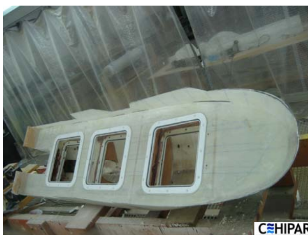
Figura 2: Escotillas estanca de acceso al interior del modelo (cubiertas superior y parque pesca)
