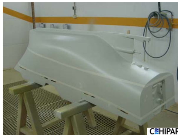
Figura 3: Vista del modelo desde ambas bandad durante la fase de pintado, pudiendo observarse la distribución de falucheras, quillote, talón de codaste y bocina.
