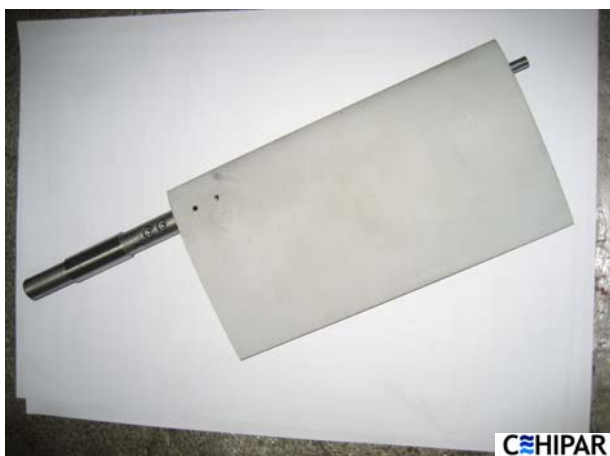
Figura 7: Vista del timón móvil desmontable y alineación en el modelo durante la fase de construcción.
