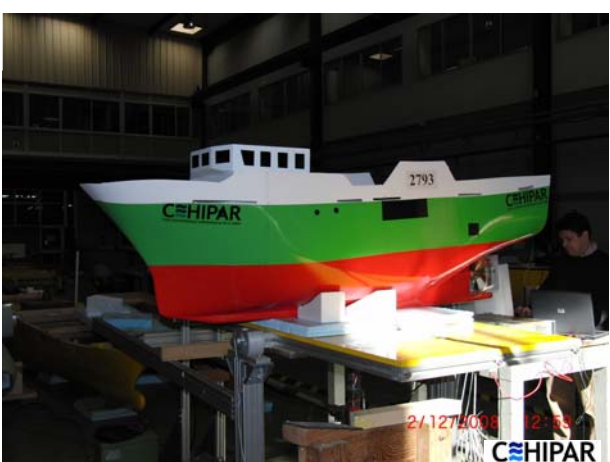
Figura 9: Modelo en la mesa de inercia. Obsérvese la simulación pintada de negro de las aperturas de la banda de babor, correspondientes a la puerta de salabardeo y al puerto de basuras.
