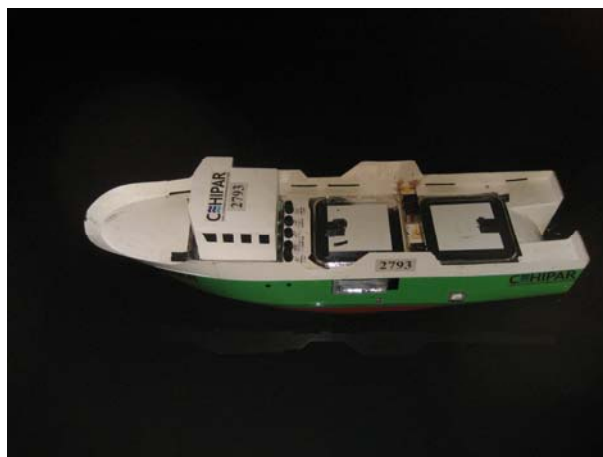
Figura 18: Situación de ensayo correspondiente a la fase 6, pudiendo observar la zona de salabardeo abierta y la apertura de basuras cerrada.
