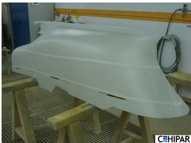
Figura 3: Vista del modelo desde ambas bandad durante la fase de pintado, pudiendo observarse la distribución de falucheras, quillote, talón de codaste y bocina.
