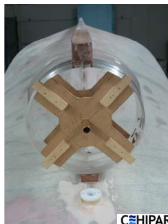
Figura 6: Vista lateral y frontal de la fase de montaje y alineación de la tobera (modelo de stock número 127) en el modelo.
