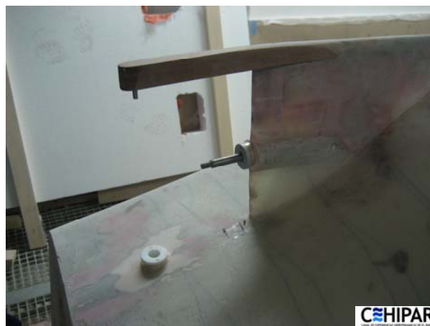
Figura 5: Detalle del quillote, talón de codaste, bocina y limera del timón durante la fase de construcción del modelo
