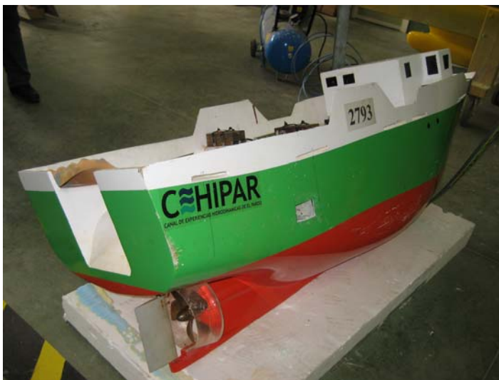
Figura 20: Situación de ensayo correspondiente a la Fase 10, pudiendo observar la avería simulada en la zona de popa estribor.
