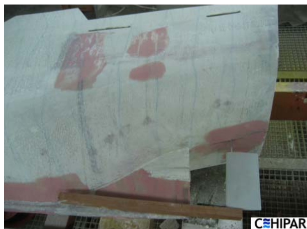
Figura 7: Vista del timón móvil desmontable y alineación en el modelo durante la fase de construcción.
