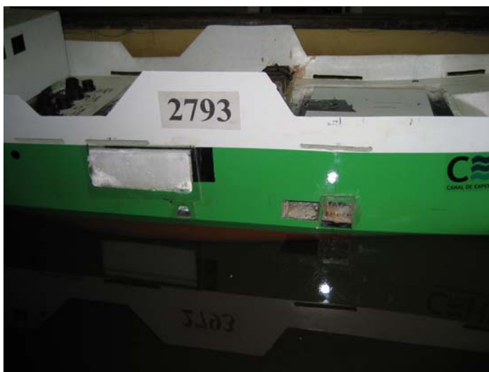
Figura 19: Situación de ensayo correspondiente a la Fase 9, pudiendo observar la avería simulada en la zona de popa babor.
