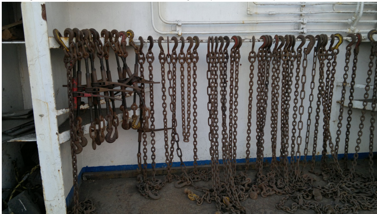
Figura 6. Elementos de trinca en el B/M LYGRA
