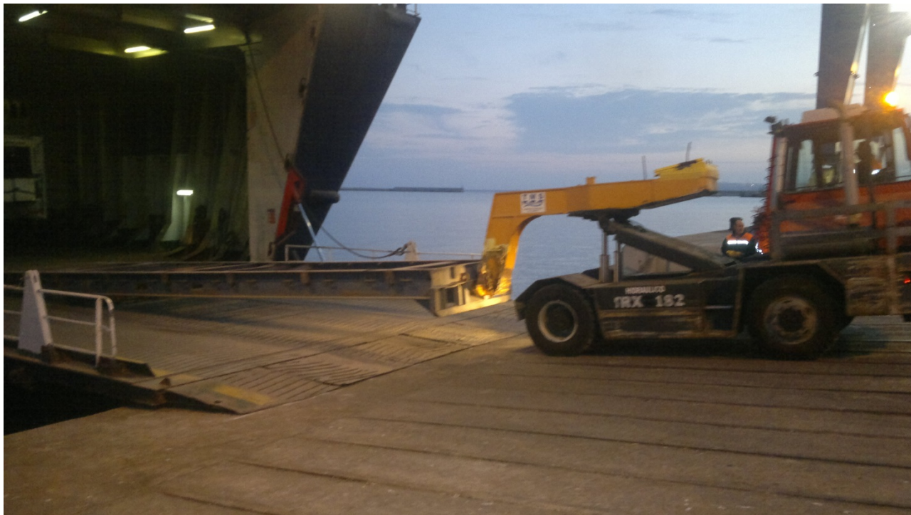
Figura 4. Tractor con cuello de cisne para remolque de las plataformas de carga.
