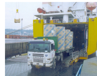
Proceso de carga en buque RO-RO
