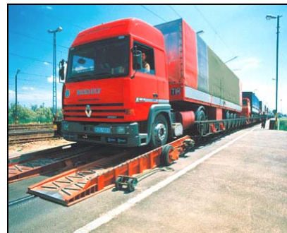
Proceso de descarga de una carretera rodante
