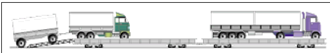
Carga de una carretera rodante
