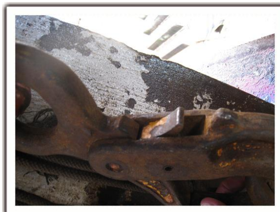
Figura 6. En la imagen superior, gancho de seguridad de la puerta sin su pestillo. En la imagen inferior, un gancho similar con el pestillo de seguridad
