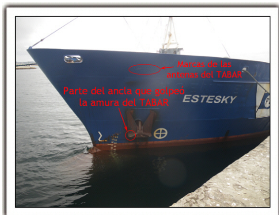
Figura 5. Marcas de la colisión en el ancla del ESTESKY
