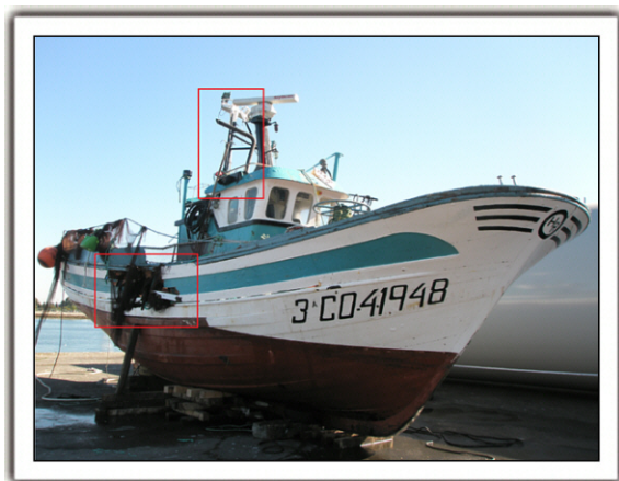
Figura 6. Daños en el TABAR: golpe del ancla del ESTESKY en el través. Palos y antenas dobladas
