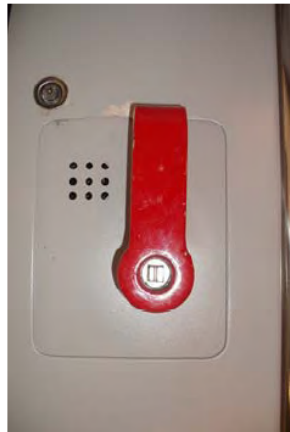
Fig 1. Maneta de apertura manual de emergencia en posición normal (maneta arriba y cuadradillo en posición vertical) .
