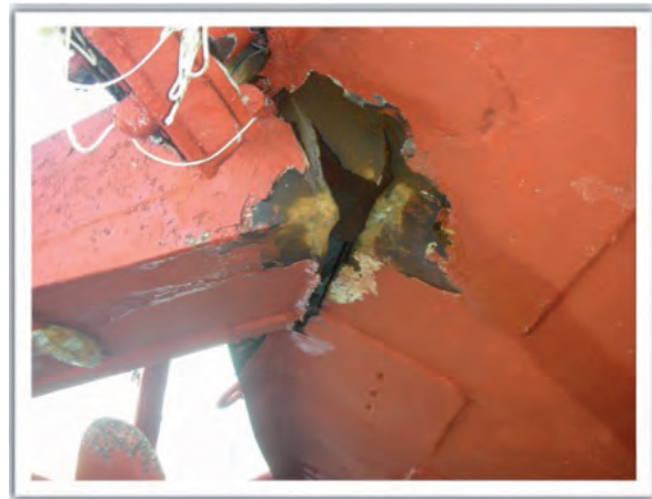
Figura 3. Rotura producida en el casco tras el primer intento de reflotar la embarcación
