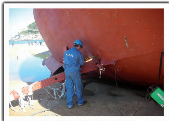
Figura 8. Corte del codaste
