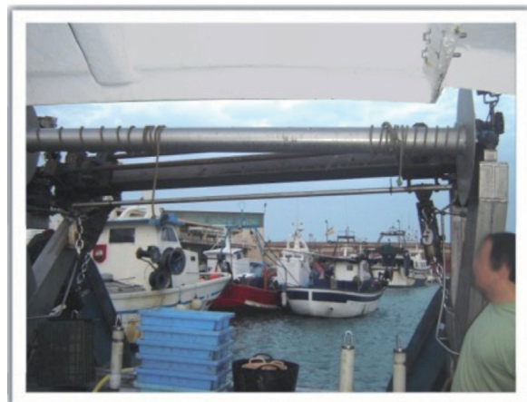
Figura 10. Rodillo del B/P GERMANS PERIS que quedó afectado por el golpe contra el pescante.
