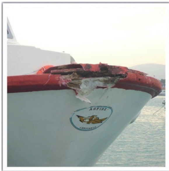
Figura 8. Daños en la proa del B/P BLANCA B
