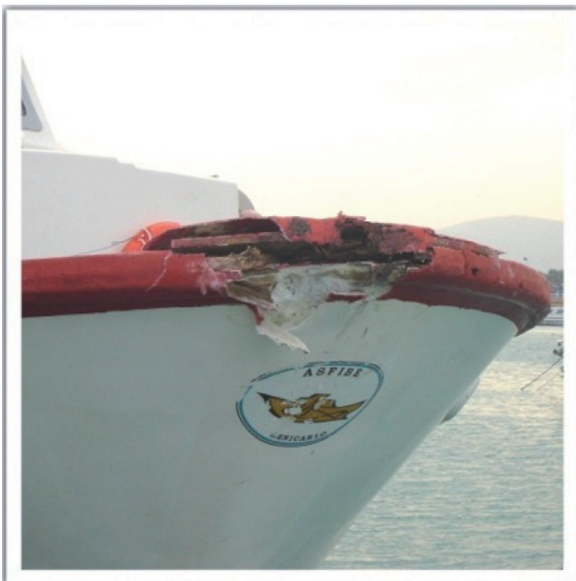
Figura 3. Daños en la proa del B/P BLANCA B
