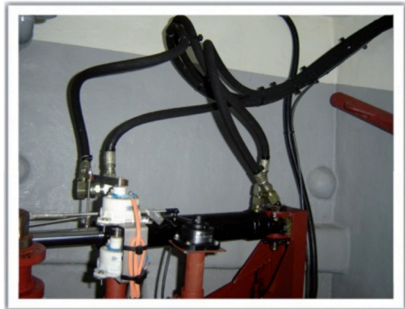
Figura 12. Latiguillos del sistema hidráulico del pescante que hubo que reemplazar
