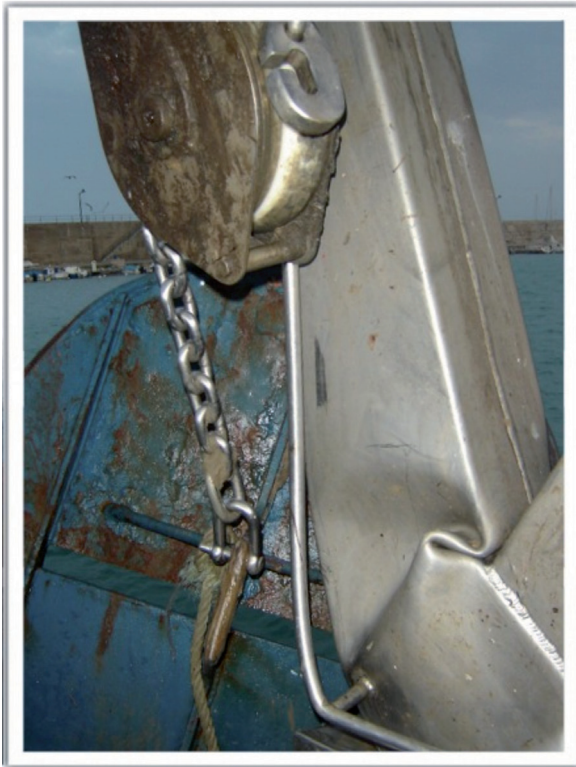
Figura 11. Brazo de estribor del pescante del B/P GERMANS PERIS tras la colisión.
