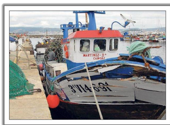
Figura 4. Daños en la E/P MARTÍNEZ SEGUNDO
