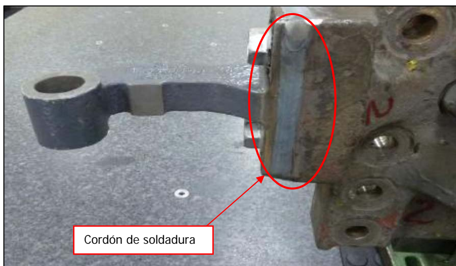
Vista de la solución adoptada mediante "cordón de soldadura". (Fuente: CAF)
