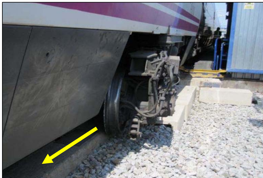
Vista de la rueda izquierda del séptimo eje descarrilada. (Fuente: Renfe Operadora)
