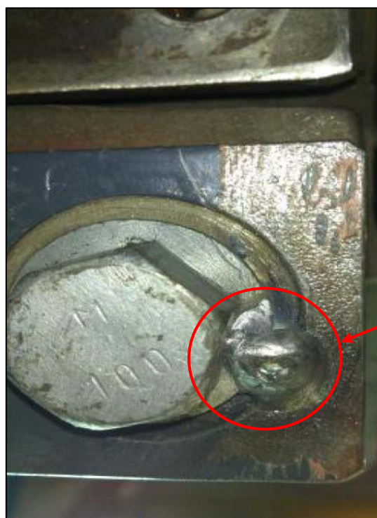
Detalle del "punto de soldadura" aplicado a la cabeza de uno de los tornillos de sujeción del soporte palanca. (Fuente: CAF)
