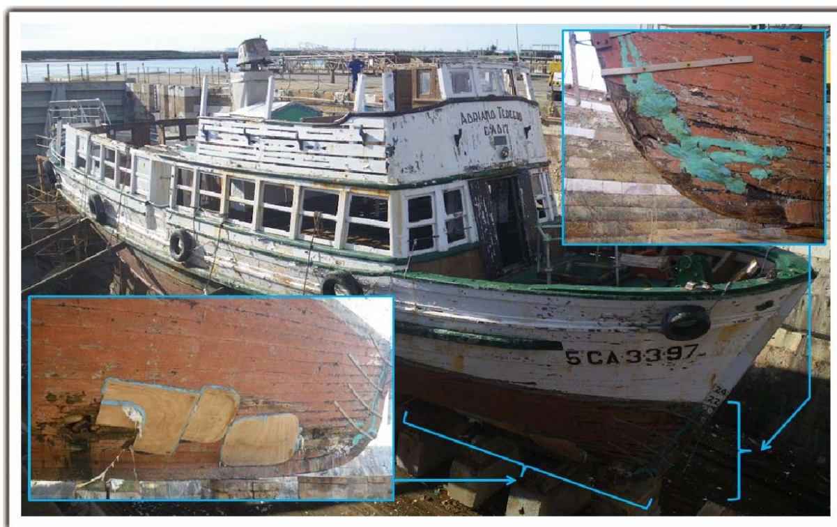
Figura 2. Vista de los daños sufridos por el buque y las reparaciones provisionales efectuadas
