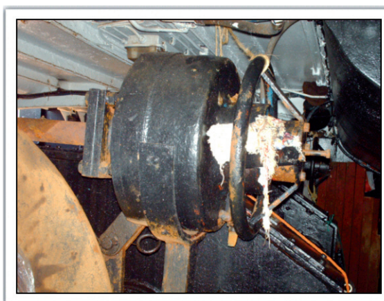
Figura 11. Volante del freno de la maquinilla de arrastre con su actuador
