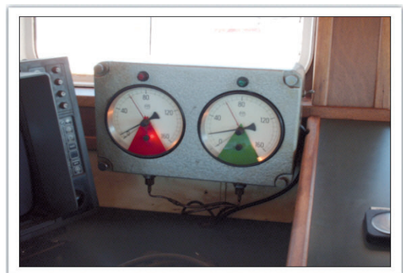
Figura 14. Indicadores de tensión en las maquinillas de arrastre, con alarma regulable
