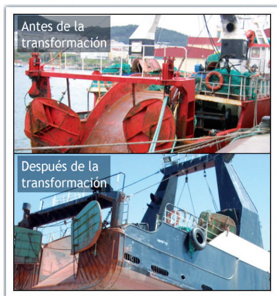
Figura 3. Modificación del pórtico
