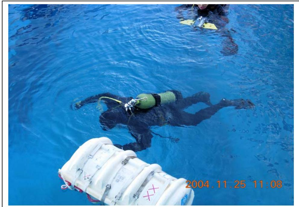
Se sumerge la balsa y se reanudan las pruebas, para conocer como influye la presión en las burbujas de aire acumulada entre los pliegues del tejido y que produce una flotabilidad de 38 Kgs.
