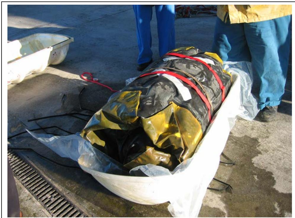
Una vez finalizada la prueba, se abre el contenedor y la balsa para proceder a su secado.
