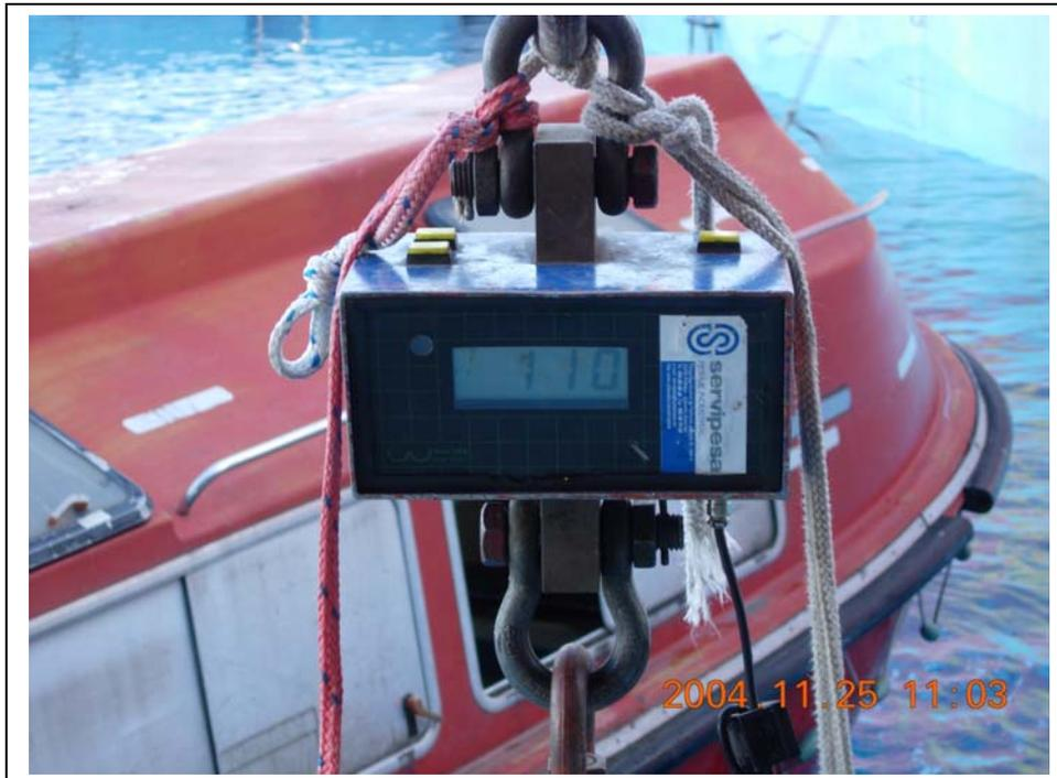
Después de someter la balsa a un ligero movimiento de olas la pérdida de flotabilidad por salida de aire acumulado entre los pliegues del tejido de la balsa es de 4 Kgs.
