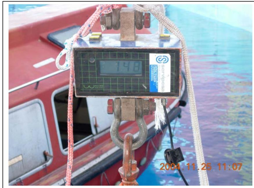
La diferencia de pesos nos indica la flotabilidad de la balsa, 38 Kgs.
