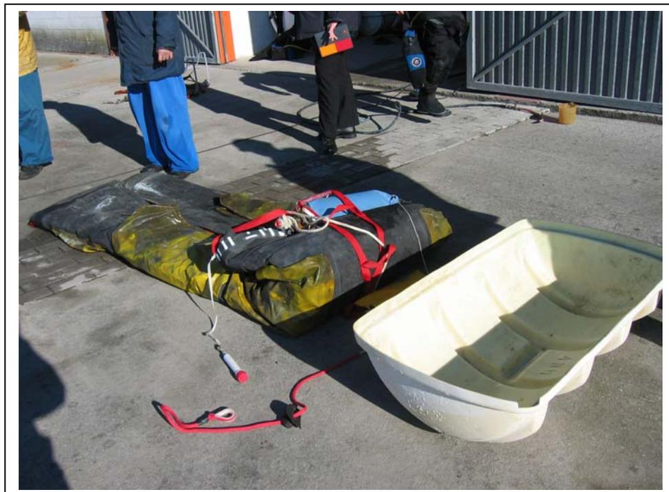
Finalizado el secado, se pliega la balsa y se introduce con todo su equipo en el contenedor, en las mismas condiciones que la situación original.
