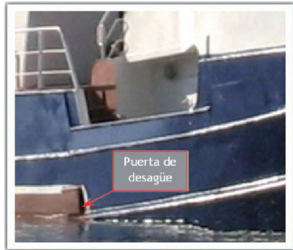
Figura 33. Puerta de desagüe del hueco de pesca
