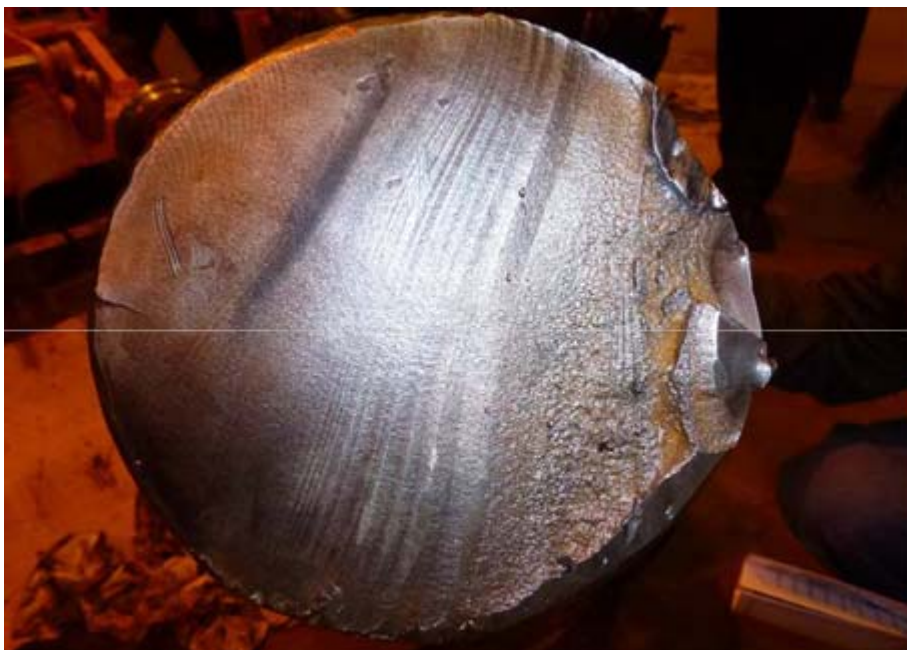
Vista de la rotura del eje en el taller de la empresa Vías y Construcciones (Fuente: Adif)
