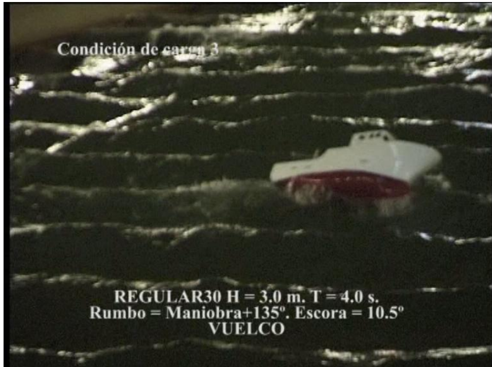
Secuencia del vuelco: Foto nº 2
