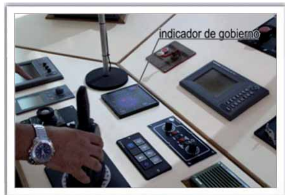
Figura 12. Joystick de estribor del BLANCA S
