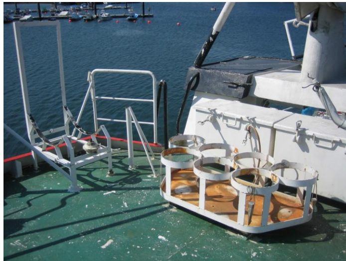
Foto 23: Vista de la cama de balsa salvavidas de estribor
