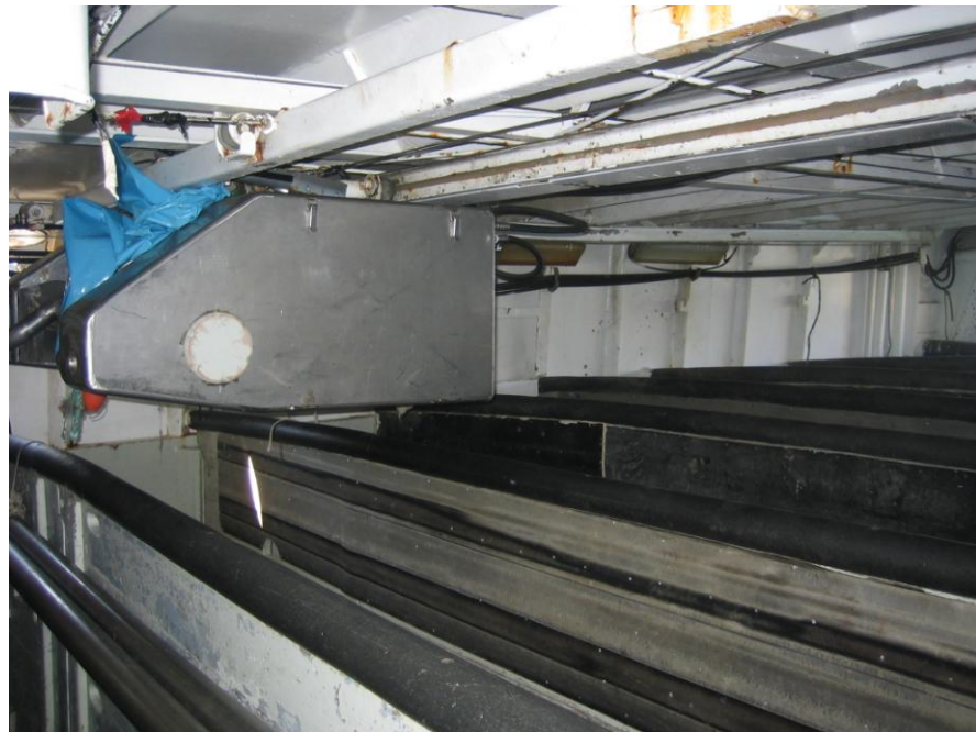
Foto 11: Maquinilla para la distribución del aparejo en el parque de pesca de popa
