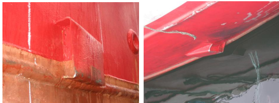
Fotos 14 y 15: Detalle del cierre de la descarga al mar parque pesca popa
