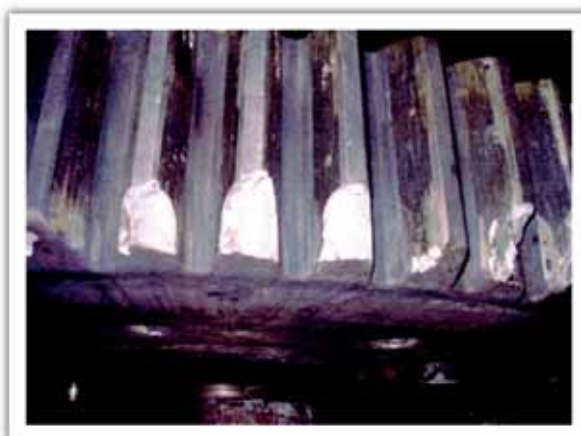
Figura 20. Corona con varios dientes rotos
