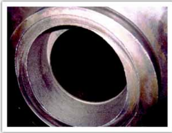
Figura 12. Casquillo con desgaste
