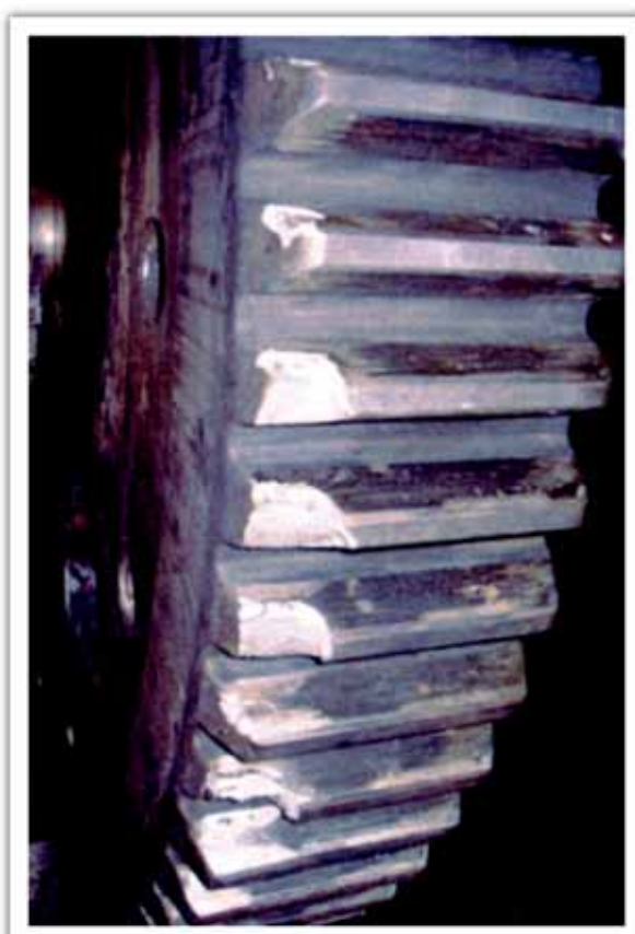
Figura 19. Corona con varios dientes rotos
