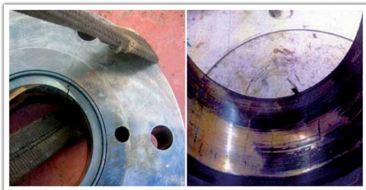
Figura 1. Aspecto del casquillo del cojinete del eje de popa babor del dampner
